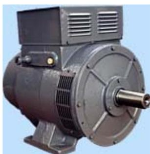
Генераторы синхронные марки ГС-250 предназначены для использования в качестве источников трехфазного электрического тока частотой 50 Гц, напряжением 400В в стационарных и передвижных электроустановках, специального электроснабжения потребителей, требующих высокого качества электрической энергии.
